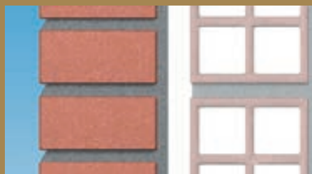
Fig. 1: Giunto a sguincio. Fig. 1: Struck Joint.
