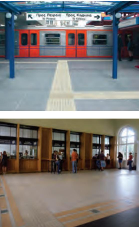
**Granitogres Tactile** est un langage spécial, empreint sur carreaux en Grès Fin Cérame permettant aux non-voyants et malvoyants de se déplacer avec une majeure autonomie et davantage de sécurité. Les éléments modulaires du pavage se composent de codes d'information faciles à comprendre, qui donnent des indications sur les directions et qui avertissent des dangers par quatre sens différents:
